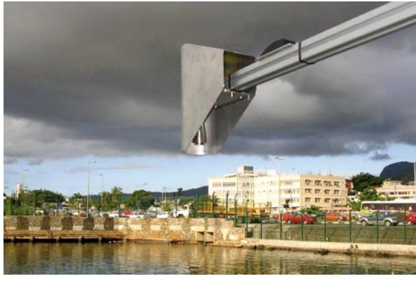
Les stations marégraphiques du GLOSS utilisent nombre d'instruments pour mesurer le niveau de la mer, notamment des radars orientés vers le bas. Port-Louis, à Maurice. Crédit photographique : Centre du niveau de la mer de l'Université de Hawaii
